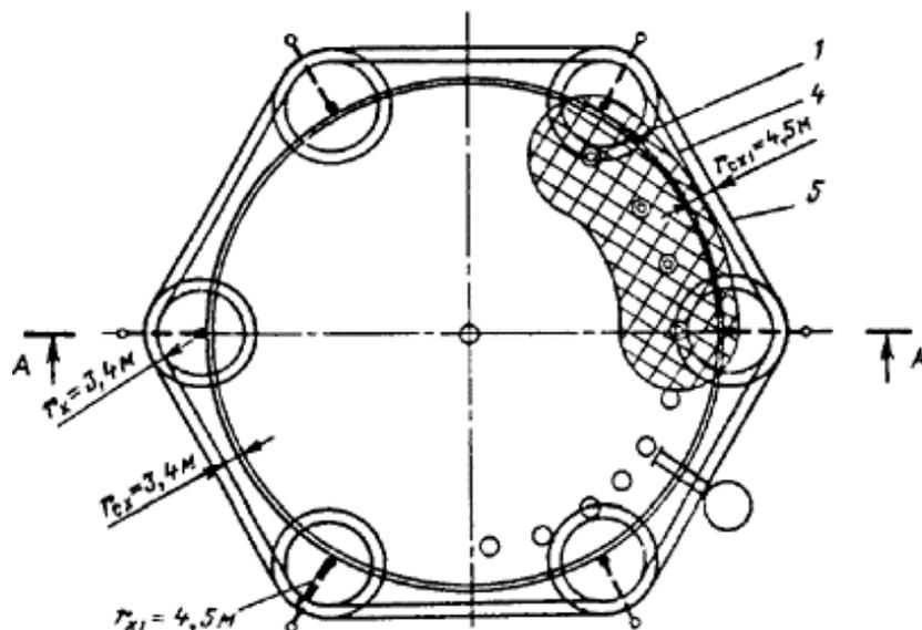
Рис. П4.7. Молниезащита металлического резервуара вместимостью 20 тыс. м<sup>3</sup> со сферической крышей:
