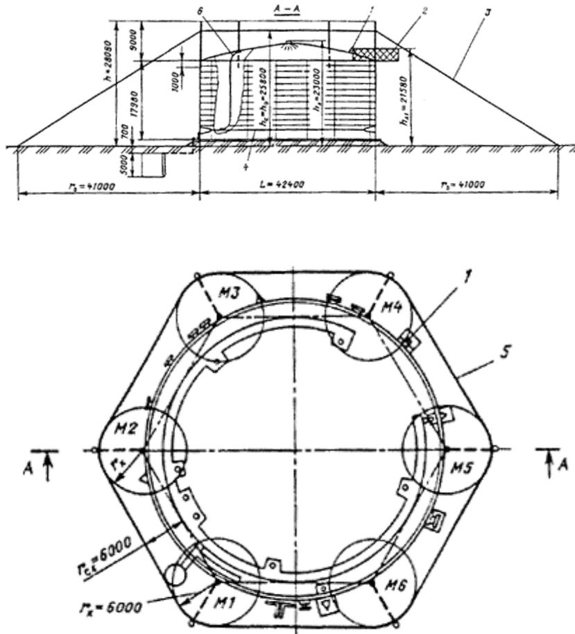
Рис. П4.8. Молниезащита металлического резервуара вместимостью 20 тыс. м<sup>3</sup> со сферической крышей и понтоном:
