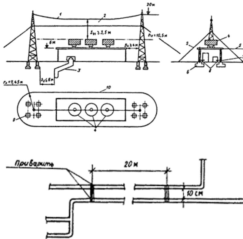
Рис. П4.3. Молниезащита здания I категории отдельно стоящим тросовым молниеотводом ( $\rho = 300 \text{ Ом}\cdot\text{м}$ ,  $S_B \leq 4 \text{ м}$ ,  $S_3 \leq 6 \text{ м}$ ,  $S_{B1} \geq 3,5 \text{ м}$ ):
